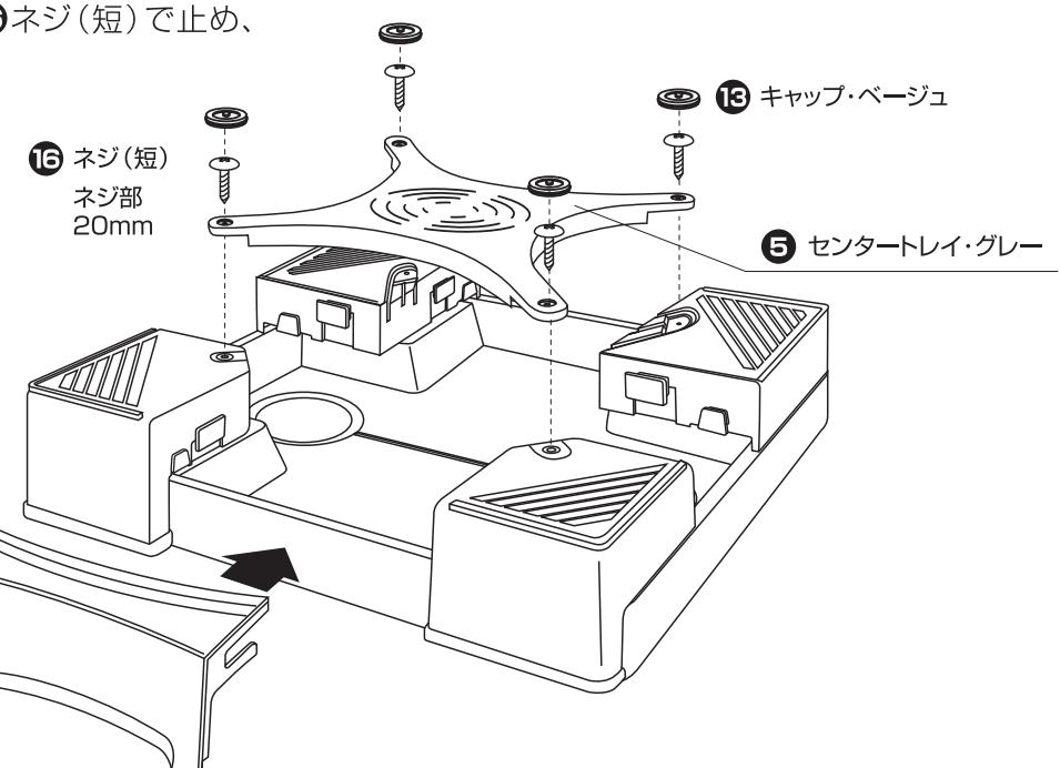
**注)** 洗濯機を乗せる時に、洗濯機の後ろ脚がきちんとマルチメゾンの後ブロックに確実に載っていることを確認しながら設置してください。
